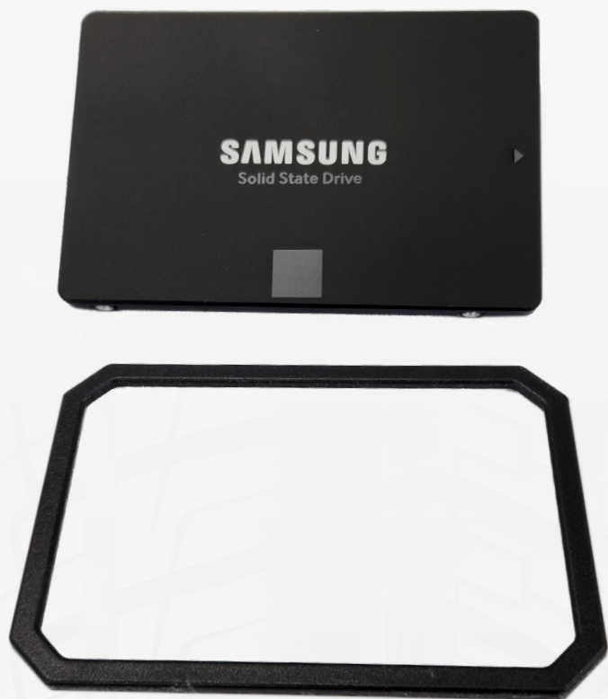
MC-1机器控制器的固态硬盘升级
